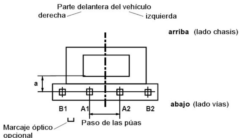
**Figura 1:** Vista de frente del cajetín de enganche y del conector estándar de 4 púas mirando la extremidad 1 del vehículo<sup>4</sup>, (paso de las púas, ver 2.2.4)
