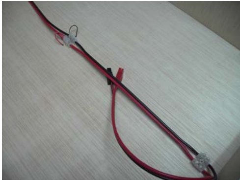
Aquesta imatge correspon a un MJ fet amb via de dos carrils i només hi ha dos cables, amb via MÄRKLIN K en portaria un de més de color groc
