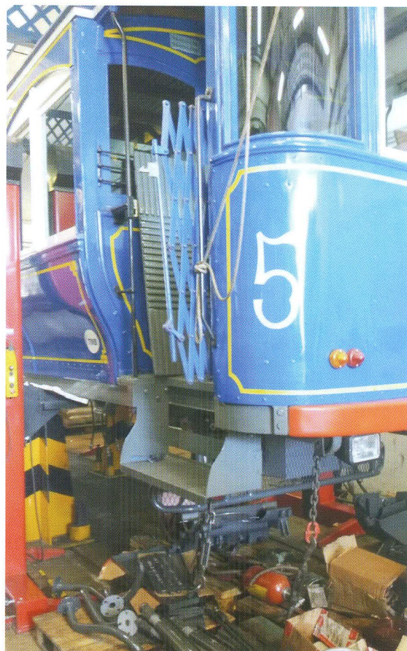
Detall dels nous elements de seguretat vial a la caixa del tranvia 5.
