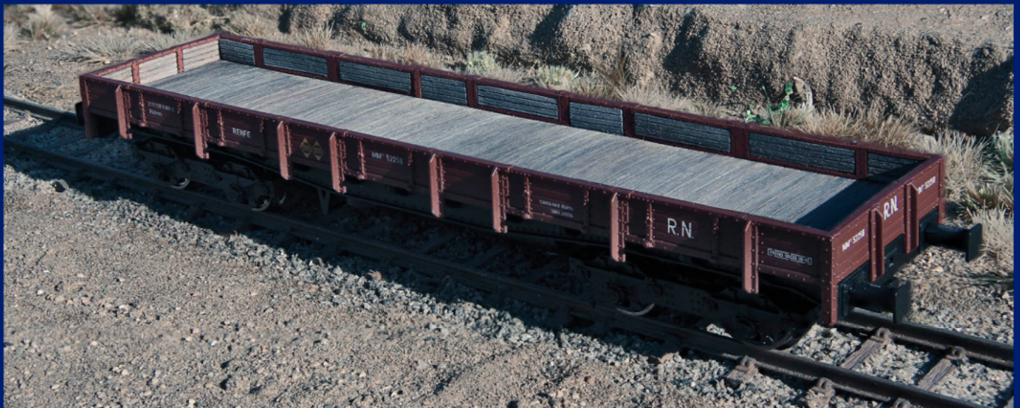
Vagón con suelo e interior montado con los perfiles pintados.
