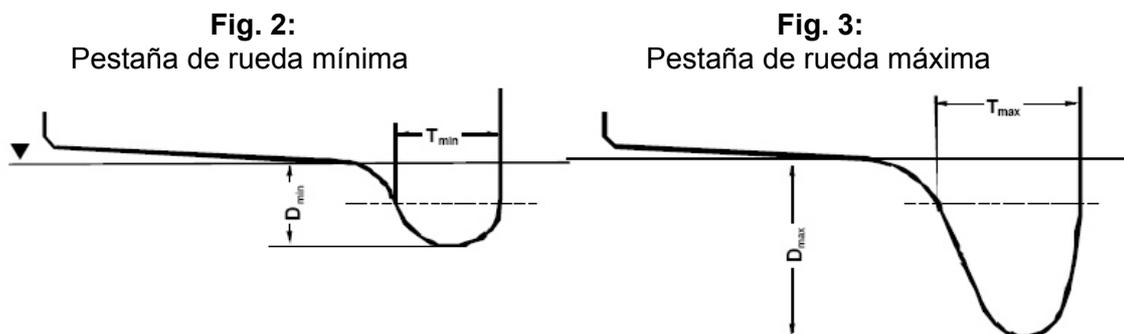
La altura de la pestaña  $D$  puede ser elegida libremente sin influencia sobre las funciones de guiado horizontal ni sobre las tolerancias autorizadas por la NEM 310G. No se permite una disminución muy importante de esta altura por debajo del valor mínimo de la dimensión  $T$  de la pestaña de rueda.
