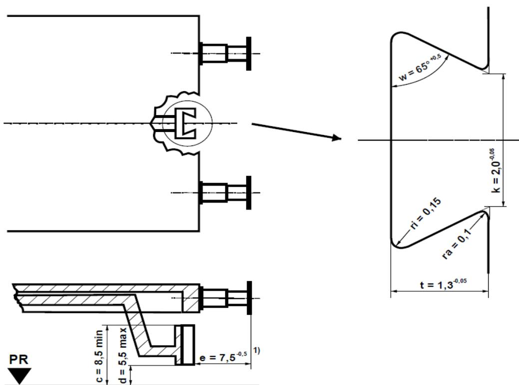
Las cabezas de enganche llevan un gancho en forma de cola de golondrina que puede ser introducido por arriba o por debajo en un receptáculo de idéntica forma. Por la elasticidad de las dos lengüetas de la cabeza, este se mantiene firmemente en la parte receptora, pero queda, sin embargo, regulable en altura.<sup>1)</sup>
