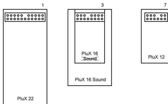
**Imagen 3:** Comparación del espacio ocupado por los módulos electrónicos correspondientes a las variantes PluX (Diseño +/- 1:1) – (Vista de la parte superior del descodificador)
