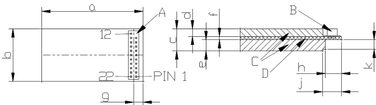
**Imagen 1:** Descodificador visto desde encima, lado de los pines de la variante compacta.
